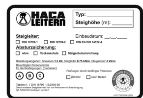
Abb. 3: Kennzeichnungsschild nach DIN 18799
