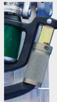
② Verschleißmarkierung Reibrad Rot = Austausch erforderlich
