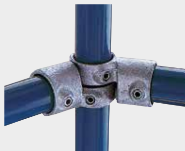
Best.-Nr. 0520 4801 00 Eckgelenk mit Durchgang, zweigeteilt, daher verstellbar von 90° – 180°.
