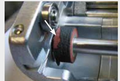
② Verschleißmarkierung Reibrad Rot = Austausch erforderlich
